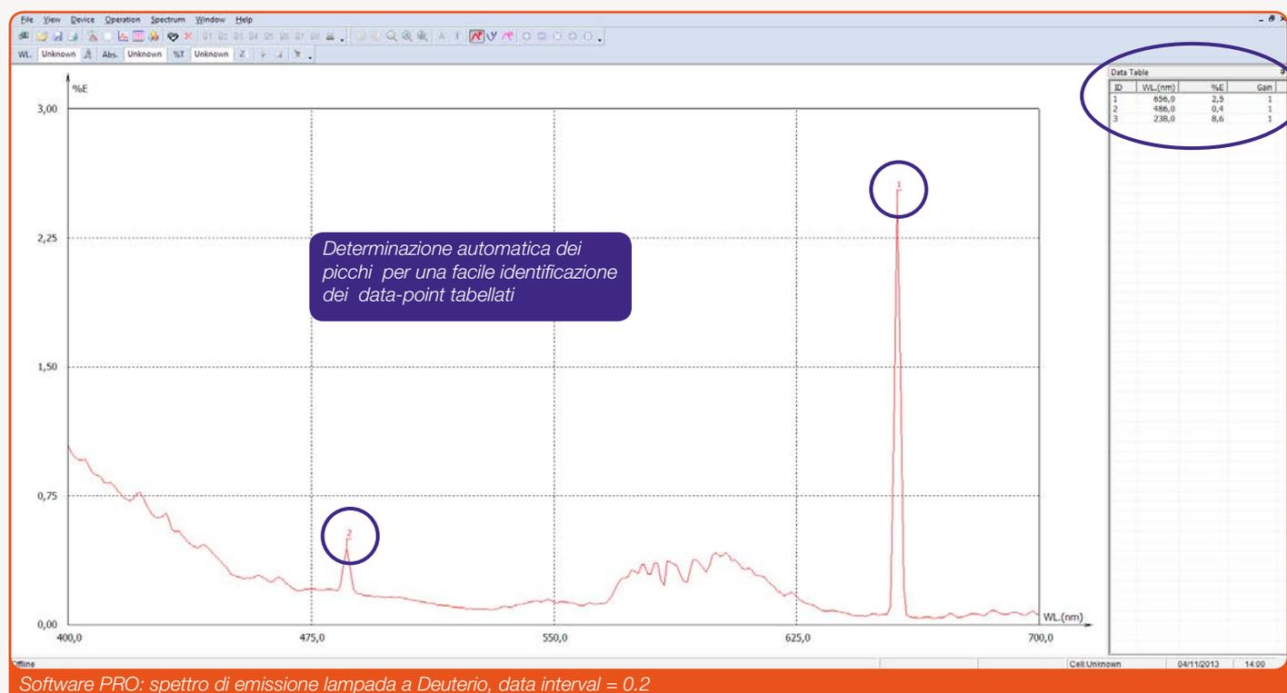
Software PRO: spettro di emissione lampada a Deuterio, data interval = 0.2
