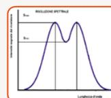
**Il potere risolvete:** esprime la capacità del monocromatore di separare tra loro due diverse lunghezze d'onda. Solitamente, dato che si lavora con bande invece di righe si preferisce parlare di **risoluzione spettrale**, intesa come la distanza fra due diverse lunghezze d'onda che consente di separare due bande all'80% della rispettiva energia.
