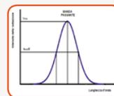
**L'ampiezza della banda passante:** è l'intervallo di lunghezze d'onda del fascio che emerge dalla fenditura con un'energia superiore al 50% dell'energia della radiazione nominale, e viene espressa in nanometri.
