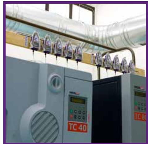
Controllo temperatura per mappatura stufe da laboratorio
